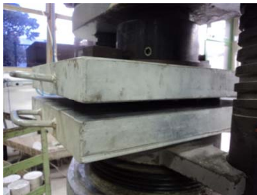
Foto 02 – Compressão do Ecopavimento preenchido com areia
